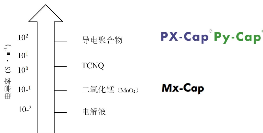
图 2. 典型电容器电解质电导率图
